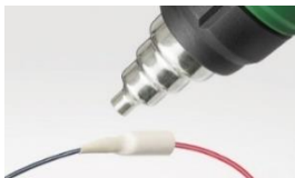
熱収縮チューブの加工
